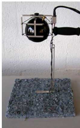
図2. 表面インピーダンスの測定状況
